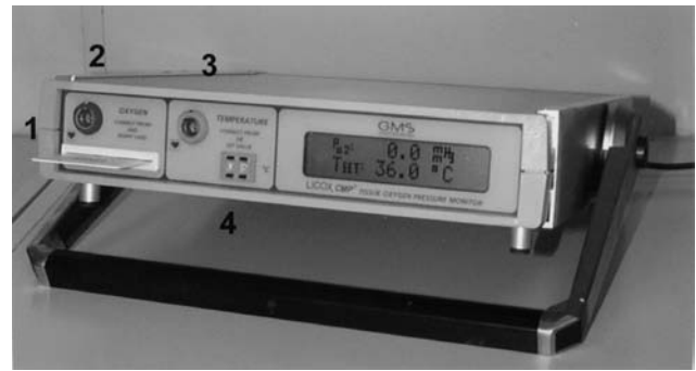
Figura 3. Esquema del panel frontal del monitor Licox. En la ranura de la derecha del monitor se introduce la tarjeta que contiene la información sobre la calibración de cada sensor (1). El monitor permite la conexión simultánea de un sensor de PtiO 2 (2) y de un sensor de temperatura (3). El sensor de temperatura es opcional, aunque el monitor requiere esta variable de forma obligatoria para proporcionar valores fiables de PtiO 2 . Si no se utiliza un sensor de temperatura esta información debe introducirse de forma manual (4).
